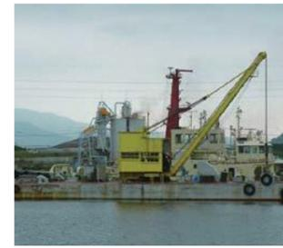
大阪港築港に用いられ、三池港築港作業にも使用されたイギリス製の蒸気式の浮きクレーン船で、吊り上げ荷重は15トンを誇ります。石炭を燃料としているため、稼働するためには2～3時間を要します。
